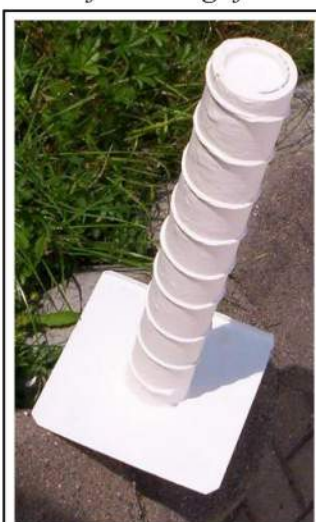
Bild 5: Helix-Antenne für zirkular polarisierte electromagnet. Wellen
