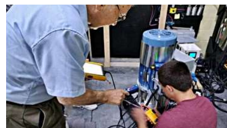
Die durch die Messingenieur eines deutschamerikanischen Unternehmers getätigten Messungen an einem 10-kW-ILPG ergaben einen COP von 4:1.
