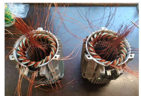
Blick auf zwei von insgesamt sechs Spulen, die Steve Gillis neu angefertigt hatte.
