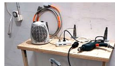
Heizlüfter und Bohrmaschine als Lastsimulation der 3-kW-E-Cat-SKLep-NGU-Anlage
