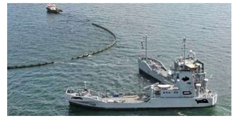
Dieses Öl-Plastik-Sammelschiff mit zwei Rümpfen, die bei der Normalfahrt geschlossen sind und beim Einsatz um ein Scharnier im Heckbereich geöffnet werden können, entwickelte Dieter Fehner vor 38 Jahren zusammen mit der Lühring Schiffswerft in Brake Nds. Es ist aktueller denn je.
