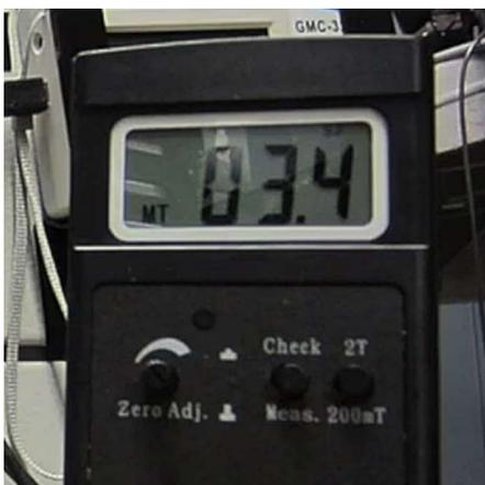
Messwert der Magnetfelder in der Nähe des E-Cat-SK in Milli-Tesla.
