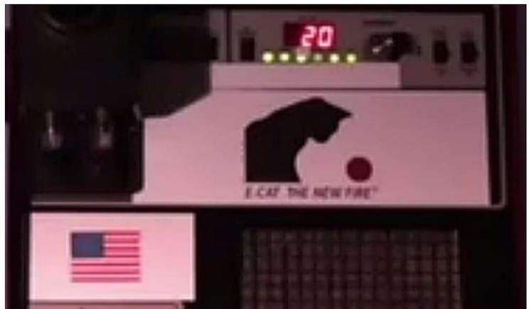
Der angezeigte Messwert gibt den Eingangsstrom von 20 A wieder. Unterhalb des E-Cat-Logos ist ein Kühlgitter zu sehen, durch das ein Teil der Wärme mittels Lüfter in den Raum geblasen wird. Die amerikanische Flagge zeigt, dass der E-Cat-SK in den USA hergestellt wird.
