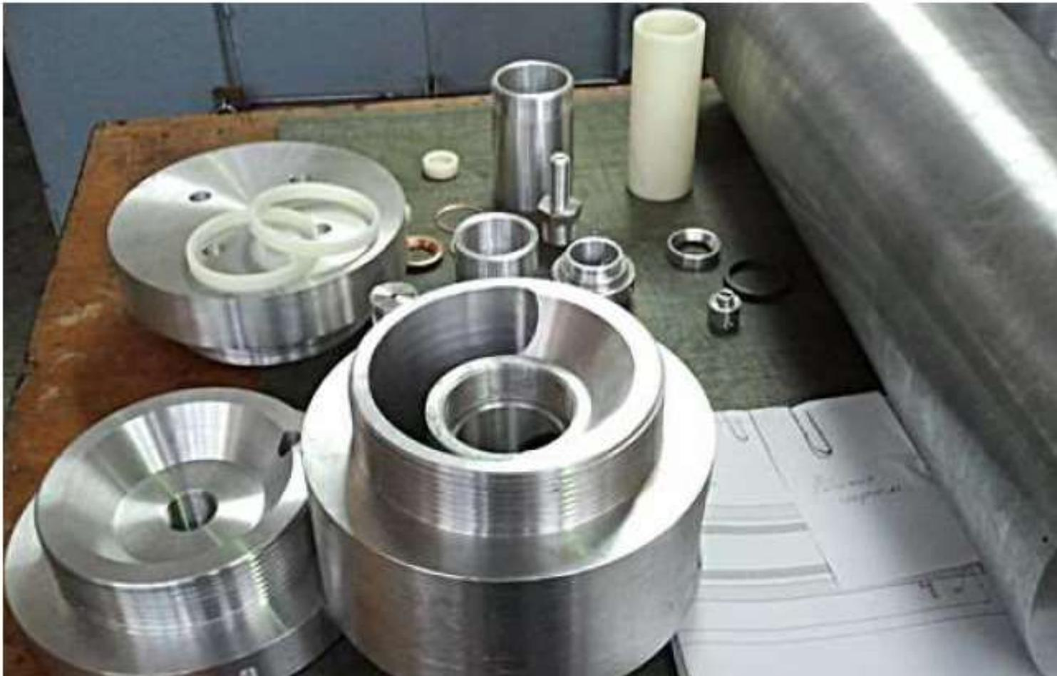
Stahlkomponenten, die für das Energieaggregat benötigt werden. Ganz rechts der Hauptzylinder, links davon die piezoelektrische Keramikröhre zur Umsetzung der hydraulischen Druckvibrationen in gepulste Hochspannung.
