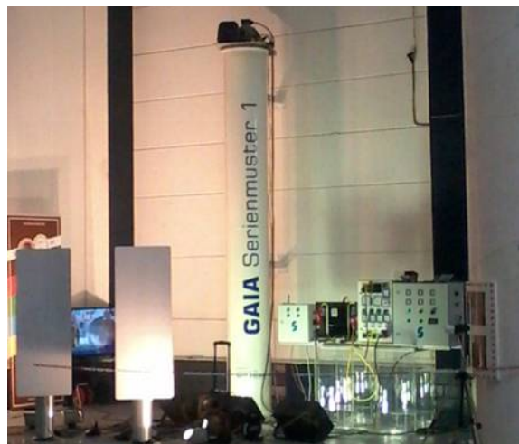
Bild 9: Auftriebskraftwerk (GAIA, Sabine Münchow)
